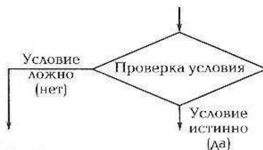
Рис. 2.26. Обозначение шагов для схемы разветвляющейся алгоритмической конструкции
