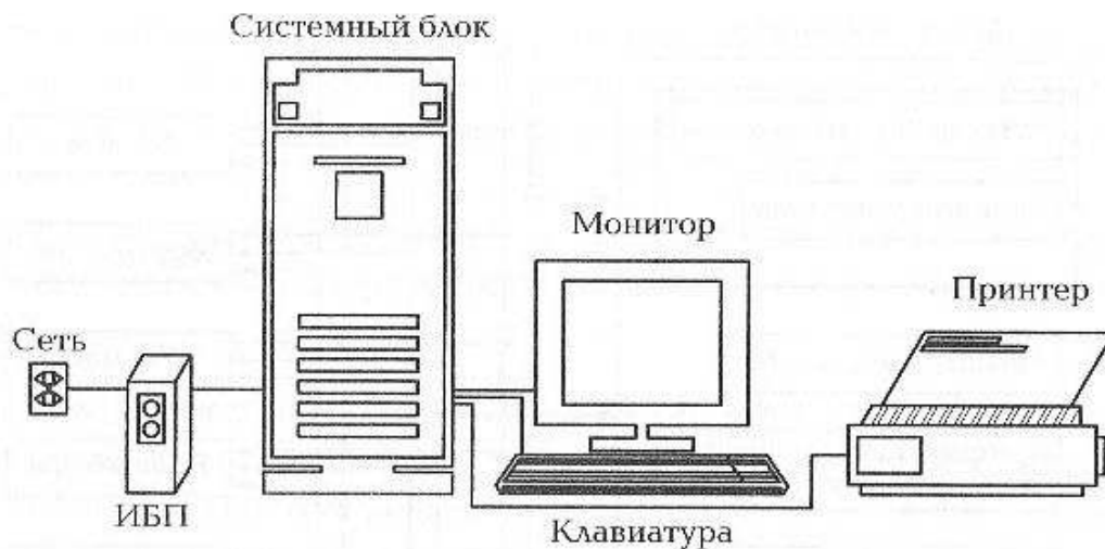
Рис. 3.4. Типовой состав ПК:
