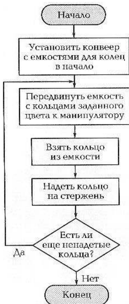
Рис. 2.23. Структурная схема алгоритма для работа-манипулятора
